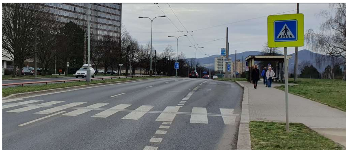
Foto 18 Západní zastávka „Sociální péče“ – nedostatečný prostor pro průchod nevidomého podél přirozené vodící linie za přístřeškem zastávky
