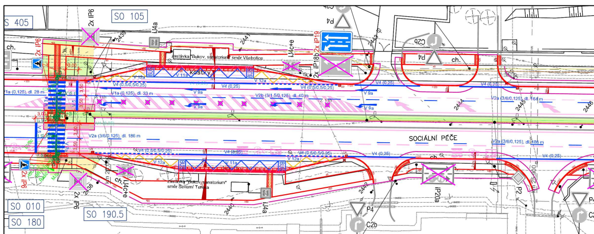
Obr. 6 Návrh rekonstrukce přechodu pro chodce u zastávek MHD „Bukov, Sanatorium“
